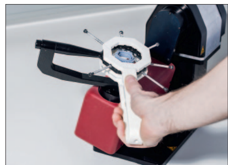
3D-gedruckte Spannbefestigung für die 1zu1-Messtechnik.
