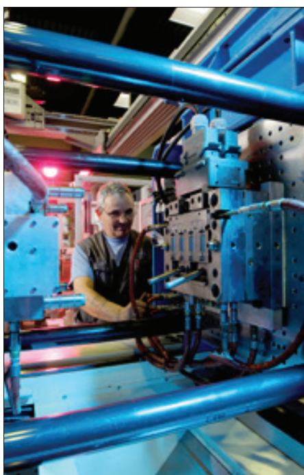
Dynamische Verstellmechanik, die durch Spritzguss in 10 Sekunden anstatt in eineinhalb Minuten zusammengebaut wird.
