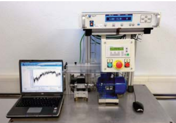
Der Reibmoment-Prüfstand ermöglicht eine praktische Bestätigung der Berechnungen
